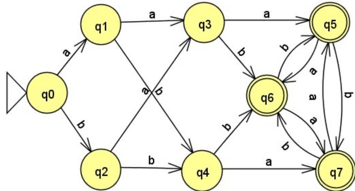
**Definition:** Zwei Zustände sind äquivalent (nicht unterscheidbar), wenn sie bei allen Wörtern zu dem selben Ergebnis führen - entweder gehen beide in einen Endzustand oder beide in keinen Endzustand.
